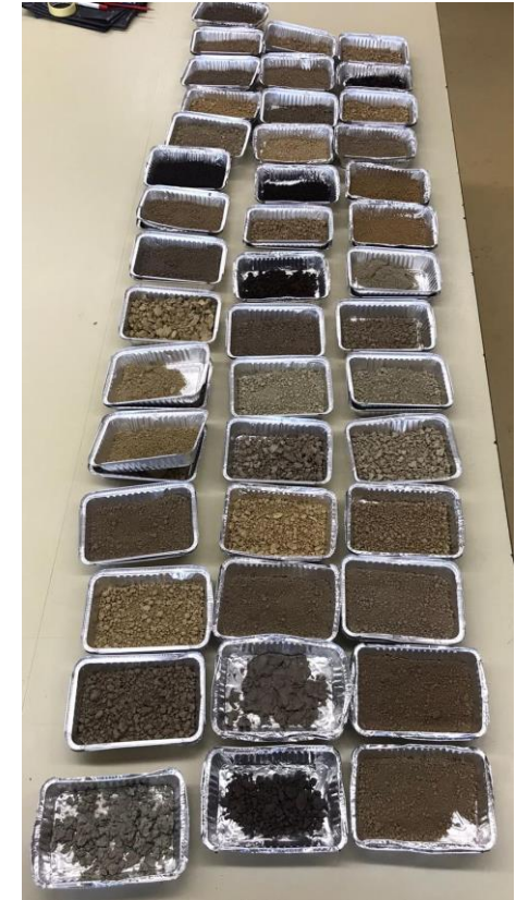
H3: Bohrungen mit automatisierter Probenahme für spektroskopische Messungen im Labor
